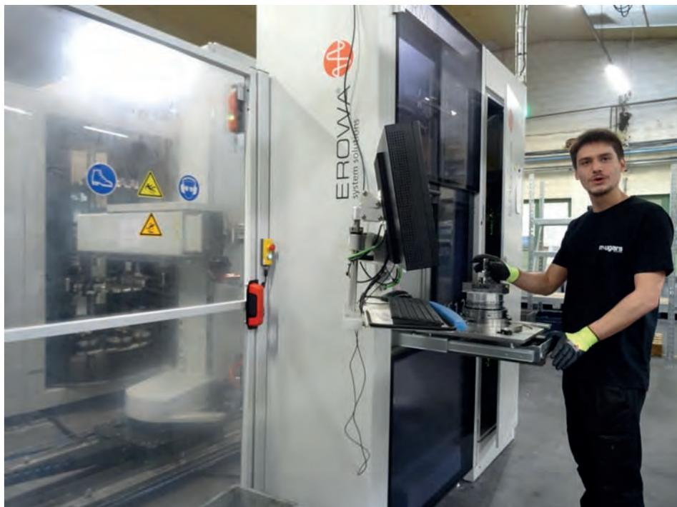
» Technicien travaillant sur un centre Makino D500 combiné à une cellule Erowa ERDL150
